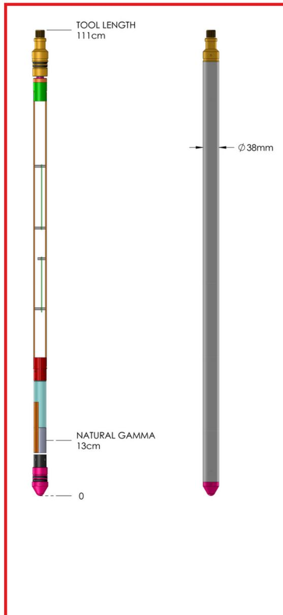
En plus de son rôle principal d'indicateur lithologique et de richesse en argile, la mesure gamma naturelle est également très souvent utilisée pour déterminer des corrélations géologiques entre plusieurs forages et assurer une bonne correspondance de la profondeur entre les différentes diagraphies effectuées dans un même forage. C'est pour ces raisons que la plupart des sondes LIM LOGGING proposent la radioactivité gamma naturel en option avec les autres mesures de diagraphie.
