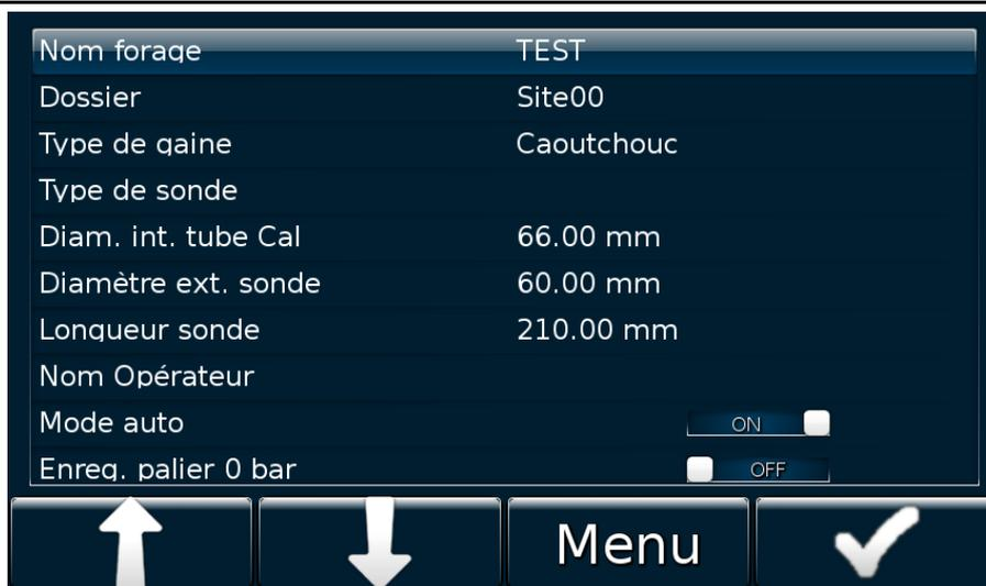
Figure 13 : Menu de paramétrage d'un essai de calibrage
