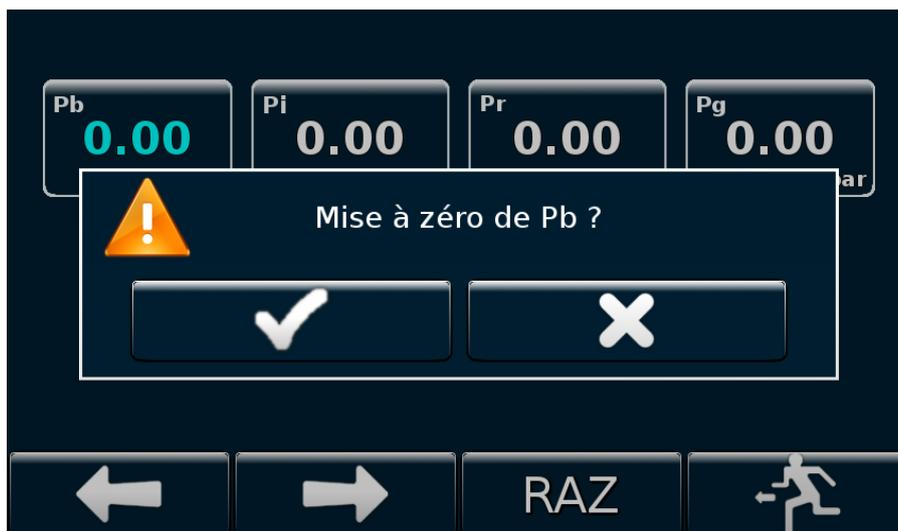
Figure 8 : Confirmation de remise à zéro d'un capteur pression
