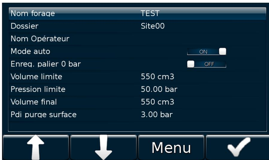
Figure 15 : Menu de paramétrage d'un essai d'inertie
