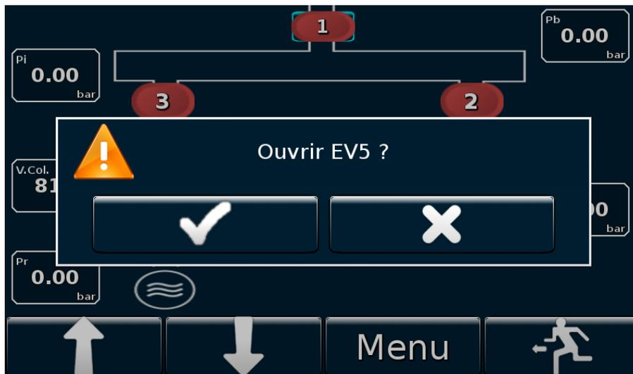
Figure 25 : Confirmation de l'ouverture d'une électrovanne
