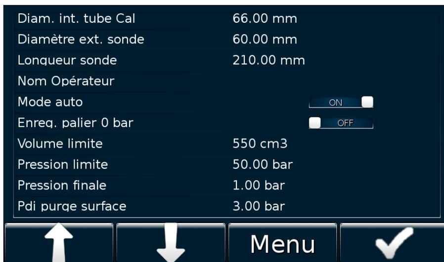
Figure 14 : Menu de paramétrage d'un essai de calibrage (suite)
