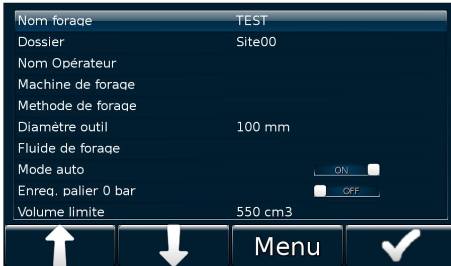
Figure 16 : Menu de paramétrage d'un essai terrain
