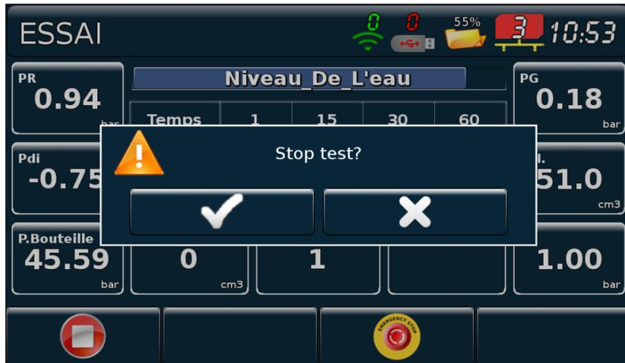
Figure 22 : Confirmation de l'arrêt manuel de l'essai
