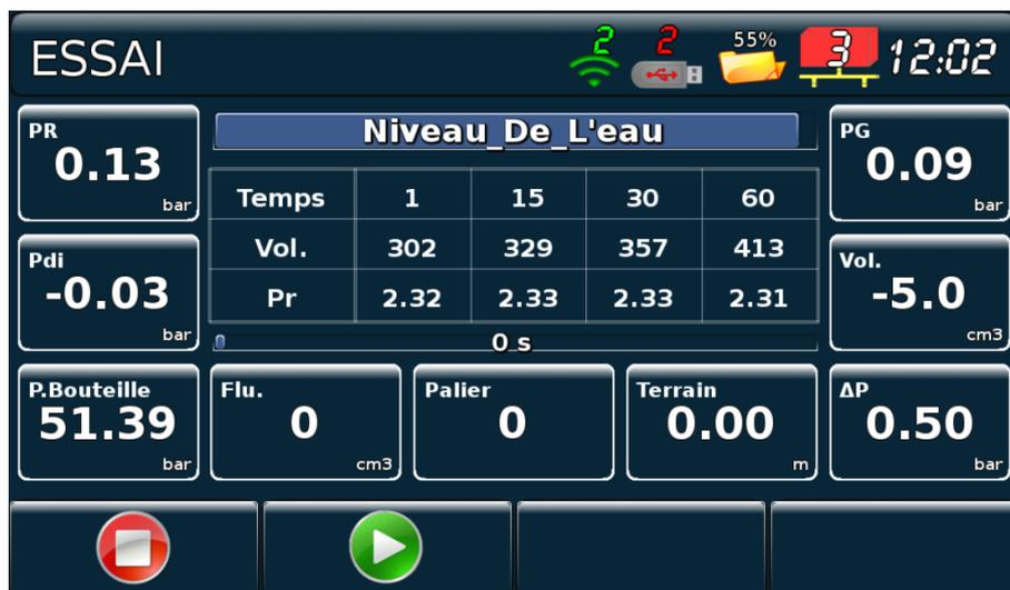
Figure 19 : Menu mesure avant le lancement d'un essai
