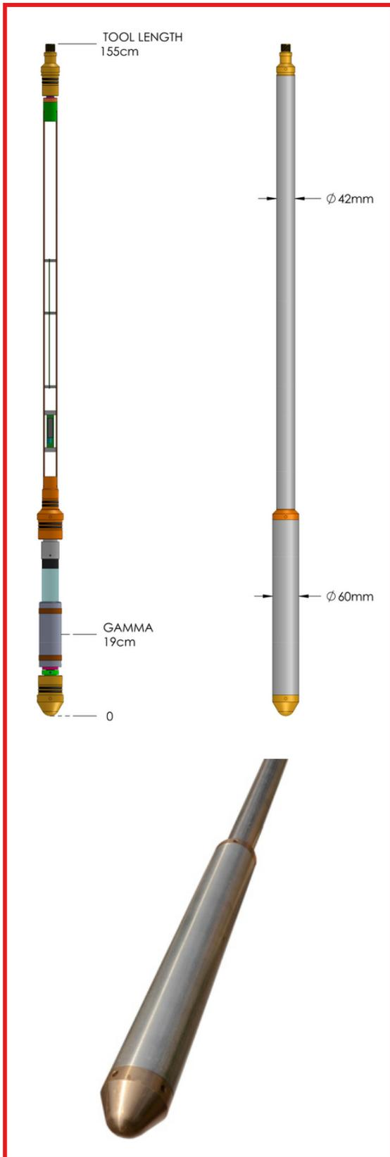
Le dispositif de détection est composé d'un cristal NaI cylindrique 25 x 50 mm (**GRS42**) ou 50 x 150 mm (**GRS60**) couplé à un tube photomultiplicateur qui est stabilisé thermiquement.
