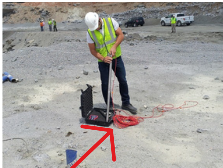
Câble gradué pour se repérer en profondeur
