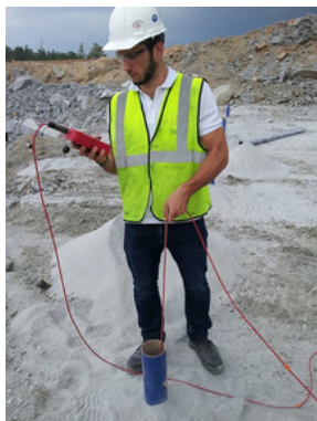
Câble gradué pour se repérer en profondeur
