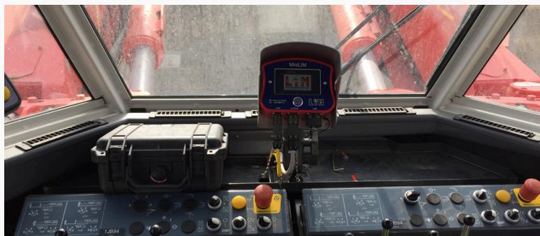
MiniLIM-Forage installé dans la cabine d'une machine de forage pour travaux souterrains (jumbo de foration)
