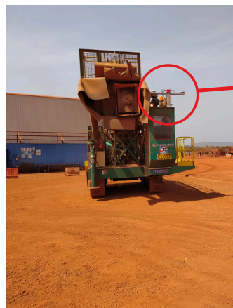
Antena de recepción GPS RTK dual (al menos 1 m de distancia) ubicada en la cabina de perforación con caja de interfaz CANBUS.
