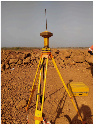
Transmisión de antena de base fija Corrección GPS RTK.
