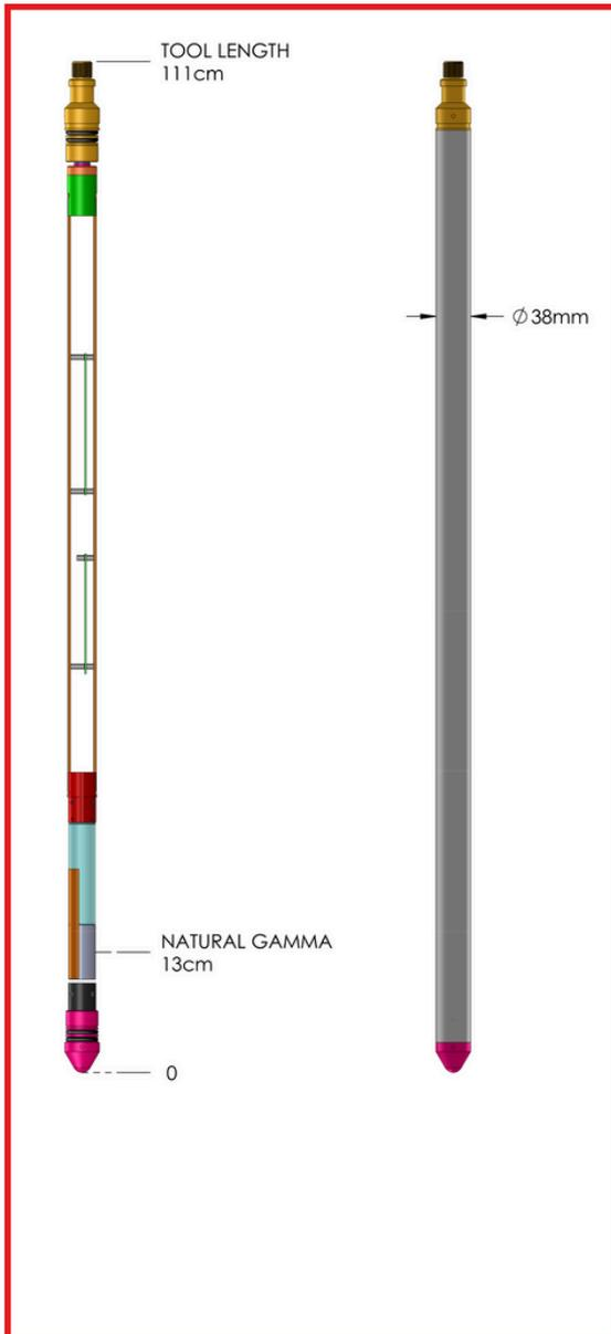
Además de su función principal como indicador litológico y riqueza de arcillas, la medición gamma natural también se utiliza muy a menudo para determinar correlaciones geológicas entre varios pozos y para asegurar una buena correspondencia de la profundidad entre los diferentes registros realizados en el mismo pozo. Es por estas razones que la mayoría de las sondas LIM LOGGING ofrecen radiactividad gamma natural como una opción con otras mediciones de registro.
